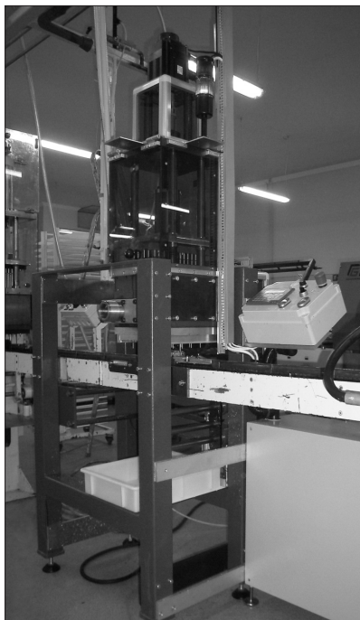
Rys. 2. Dozownik w ciągu technologicznym
