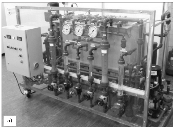
Rys. 1. Pilotowa instalacja badawcza a) widok ogólny, b) schemat ideowy: MF, UF – moduł mikro- lub ultrafiltracyjny, R – retentat, ZN – zbiornik nadawy, ZP – zbiornik permeatu, P1, P2 – pompy, M – manometr, FS – filtry tkaninowe
