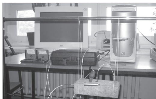
Rys. 2. Stanowisko badawcze: element mурowy podwieszony na żyłce (uwolnienie stopni swobody), młotek modalny, czujniki piezokwarcowe do pomiaru drgań, komputer
