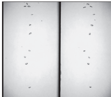
Rys. 2. Typowy obraz pęcherzyków zarejestrowany tomografem obrazowym
