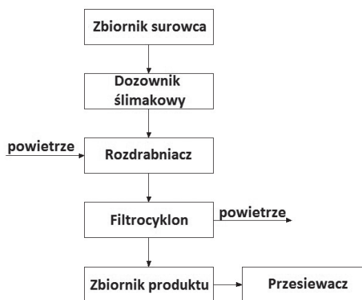
Rys. 2. Schemat blokowy układu rozdrabniającego zastosowanego w badaniach
