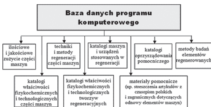
Rys. 2. Podstawowe informacje do budowy programu komputerowego wspierającego wybór metody regeneracji części maszyn
