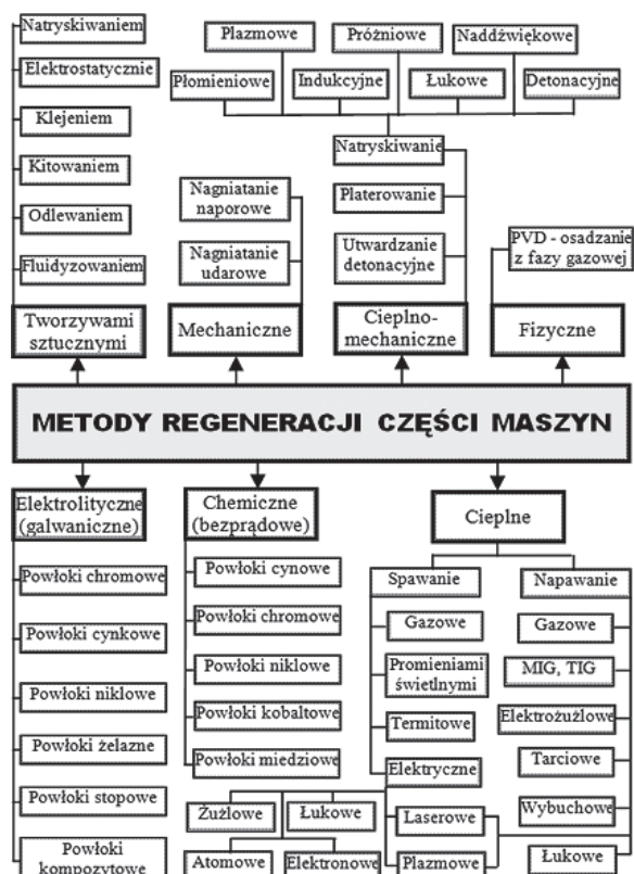
Rys. 1. Podstawowe dane do budowy programu komputerowego wspierającego wybór metody regeneracji części maszyn
