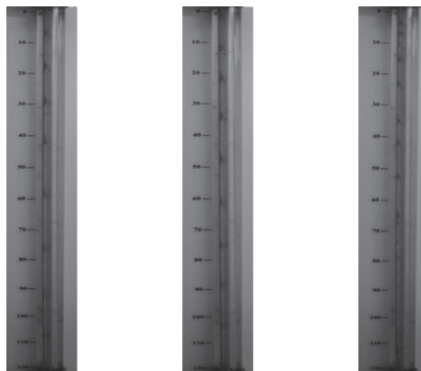
Rys. 3. Zmiany zafalowania powierzchni międzyfazowej na skutek zmian właściwości cieczy wskutek jej ogrzewania przy: w_c = 0,014 m/s, w_g = 0,8 \div 1,55 m/s, \eta_c = 370 \div 90 mPa·s
