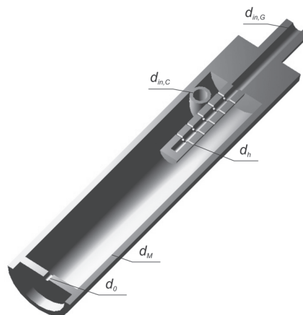
Rys. 1. Konstrukcja atomizera pęcherzykowo-wirowego
