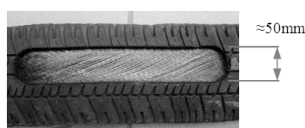
Rys. 4. Szerokość wycięcia po zastosowaniu głowicy natryskowej
