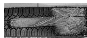
Rys. 5. Widok opony po trzykrotnej obróbce głowicą natryskową [Holka i Jarzyna, 2010]
