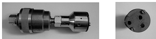
Rys. 3. Widok ogólny trójdysowej głowicy natryskowej [Holka i Jarzyna, 2011]
