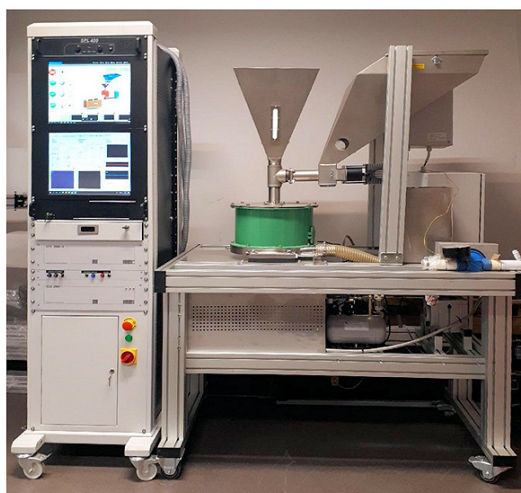
Rys. 1. Widok roboczej stacji kontroli parametrów procesu precyzyjnego rozdrabniania nasion oleistych oraz stanowiska rozdrabniacza (wersja pierwsza)
